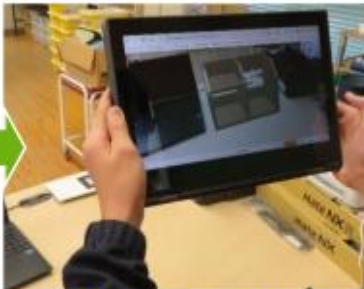
設計は3DCADで行った。その設計データはAR※ツールを用いて実際に使う場所に投影し、修正を行うなどした。
