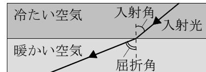
(8)では、密度が大きくて光の進む速が遅くなる冷たい空気から、密度が小さくて光の進む速が速くなるあたたかい空気へ光が入射することになるため、(6)と同様に入射角より屈折角が大きくなり、光の道すじは上向きに曲がることになる。「活用」(分析・解釈/構想)
