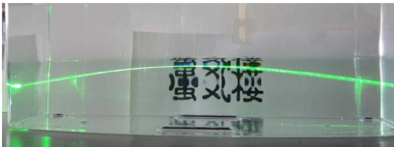
「だるま朝日」は<sup>しんきろう</sup>蜃気楼の一種で、虚像が実像の下に現れる下位蜃気楼（冬型の蜃気楼）に分類される。下があたたかく、上が冷たい状態では大気の状態は安定せず、海面であたためられた空気は上昇・拡散していくが、あたたかい海面に触れる大気の下層が絶えずあたためられるため、見かけの上では、下があたたかく、上が冷たい空気層の形になっている。このとき、光が上向きに曲げられるため、実像の下に虚像が現れる。なお、水そうを用いたモデル実験では、下から水そうの水をあたためると水の対流が起こってしまうため、教室で再現するのは困難である。
